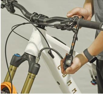
Die Abstimmung der Federelemente auf ihr Gewicht ist sehr wichtig. Regulieren sie den Luftdruck mit einer dafür konzipierten Hochdruckpumpe. Um den benötigten Luftdruck herauszufinden, konsultieren sie
