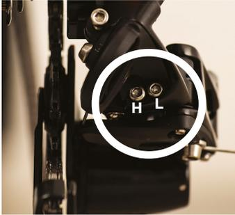
Die Endanschlagschrauben verhindern, dass sich das Schaltwerk über die Grenzen der Kassette hinaus bewegen kann. Eine Schraube bestimmt den unteren Anschlag für hohe Gänge (H), die andere den oberen Anschlag für niedrige Gänge (L). Der untere Anschlag korrespondiert mit dem kleinsten Ritzel, der obere Anschlag mit dem größten Ritzel. Stellen sie den Bereich korrekt ein, ohne die Bandbreite der Gänge zu reduzieren.
