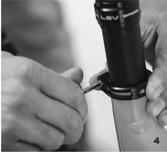
Zum Anpassen der Sattelhöhe lösen sie die Sattelstützenklemmung mit einem Inbusschlüssel, stellen die gewünschte Höhe ein und ziehen die Klemmung anschließend wieder an.
