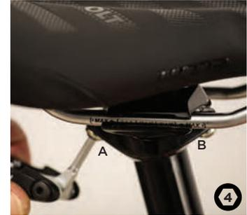
Aus Gesundheits- und Komfortgründen ist eine korrekte Position des Sattels sehr wichtig. Falsche Einstellungen können unbequem sein und Schmerzen verursachen. Um die Sattelposition anzupassen, lösen sie die Schrauben (A und B). Stellen sie zuerst die gewünschte Neigung ein und anschließend die horizontale Position.
