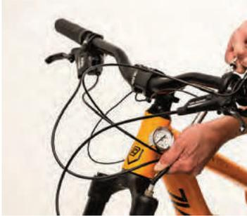
Die Abstimmung der Federelemente auf ihr Gewicht ist sehr wichtig. Regulieren sie den Luftdruck mit einer dafür konzipierten Hochdruckpumpe. Um den benötigten Luftdruck herauszufinden, konsultieren sie
