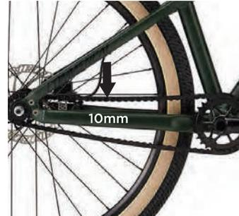
Bei Fahrrädern mit Singlespeed-Antrieb muss die korrekte Spannung der Kette überprüft werden. Die vertikale Bewegung in der Mitte der Kettenlinie sollte 10mm nicht überschreiten. Ist das nicht der Fall, ziehen sie das Hinterrad nach hinten, bevor sie die Achsmuttern fixieren. Ist ein Feinjustierer/Kettenspanner montiert, kann dieser verwendet werden.
