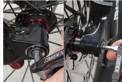
2) Schrauben sie zuerst die Achse ein (1). Ziehen sie dann die Konterschraube auf der Bremsseite an (2).
