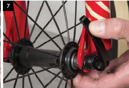
4) Schließen sie den Hebel nun vollständig vertikal. Sie sollten einen Widerstand spüren. Stellen einen festen Sitz sicher, es darf kein Spiel aufweisen. Wiederholen sie ggf. den vorherigen Schritt.
