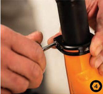
Zum Anpassen der Sattelhöhe lösen sie die Sattelstützenklammer mit einem Inbusschlüssel, stellen sie die gewünschte Höhe ein und ziehen die Klemmung anschließend wieder an.
