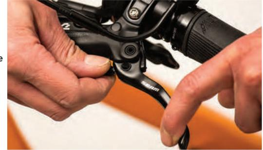
Sie können die Griffweite des Bremshebels bequem an dem entsprechenden Einstellrad feinjustieren. Dieses kann, nach Bremse, auch in Form einer Inbus-Schraube sein. Für die Wartung, Justierung, Austausch von Bremsscheiben oder Bremsbelägen etc. informieren sie sich bitte auf der Website des jeweiligen Bremsen-Herstellers.
