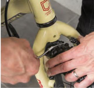
Lösen sie den Bremszug aus dem Zuganschlag, wie auf dem Foto abgebildet. Falls sie Schwierigkeiten damit haben, reduzieren sie die Zugspannung am Bremshebel oder lösen sie die Zugklemmschraube.
