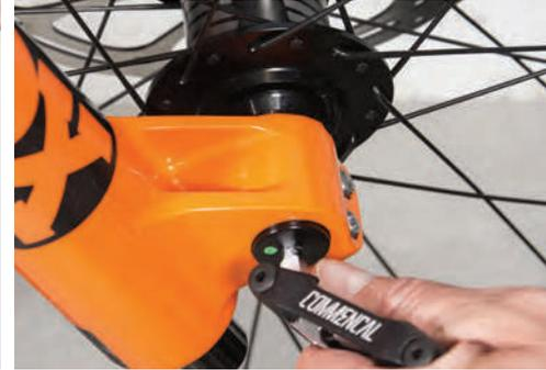
2) Setzen sie das Vorderrad ein und fixieren sie es mit der Achse, ziehen sie anschließend die Sicherungsschrauben wieder an.
