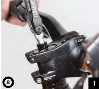
Falls gewünscht, können sie die Lenkerhöhe mit Spacern verändern. Entfernen sie dafür die Steuersatz-Kappe und lösen die Vorbau-Schrauben. Jetzt können sie den Vorbau vom Gabelschaft entfernen, um die Lenkerhöhe zu bestimmen.
