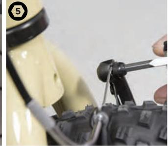
Lösen sie die Zugklemmschraube und ziehen sie mit der Hand am Zug. Sobald sich die Beläge dicht an der Felge befinden (ohne sie zu berühren), schließen sie die Zugklemmschraube wieder. Erhöhen sie die Spannung der Rückzugfeder, um die Beläge gleichmäßig an der Felge auszurichten. Betätigen sie die Bremse und überprüfen sie die Ausrichtung der Beläge. Wiederholen sie ggf. den Vorgang.
