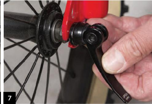
2) Montieren sie die Schnellspanner Achse in geöffneter Position, falls mitgeliefert, vergessen sie nicht die Sicherungsringe.
