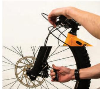
Ziehen sie, bei gezogener Bremse, die Befestigungsschrauben des Bremssattels wieder an. Kontrollieren sie, ob die Bremse schleifrei läuft. Wenn das Ergebnis nicht zufriedenstellend ist, wiederholen sie den Vorgang.
