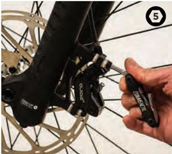
Um den Bremssattel an der Bremsscheibe auszurichten lösen sie die beiden Schrauben leicht, etwa um eine halbe Umdrehung. Drehen sie das Laufrad und betätigen sie die Bremse.
