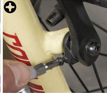
Spannen sie den Bremszug wieder ein und lösen sie die Schraube für die Rückzugfeder um ein paar Umdrehungen.
