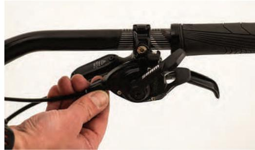
Sobald die Anschlagschrauben korrekt justiert sind, muss die Zugspannung eingestellt werden. Schalten sie dazu durch die Gänge:
