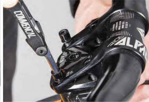
2) Montieren sie den Vorbau auf der oberen Gabelbrücke und richten sie den Lenker mit Hilfe der lasergravierten Markierungen aus.
