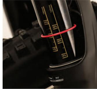
Stellen sie sich fahrbereit, inklusive Ausrüstung, auf ihr Fahrrad. Je nach Einsatzbereich sollten die Federelemente etwa 25-30 % einfedern.
