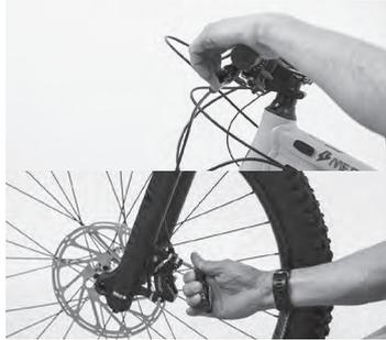
Ziehen sie, bei gezogener Bremse, die Befestigungsschrauben des Bremssattels wieder an. Kontrollieren sie, ob die Bremse schleiffrei läuft. Wenn das Ergebnis nicht zufriedenstellend ist, wiederholen sie den Vorgang.
