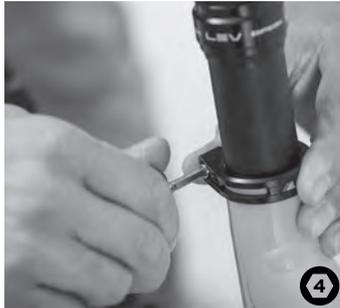
Zum Anpassen der Sattelhöhe lösen sie die Sattelstützenklemmung mit einem Inbusschlüssel, stellen sie die gewünschte Höhe ein und ziehen die Klemmung anschließend wieder an.
