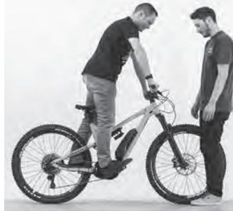
das entsprechende Hersteller-Handbuch. Bei Stahlfeder-Dämpfern erhöhen sie ggf. die Feder-vorspannung, bis der gewünschte SAG-Wert erreicht ist.
