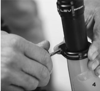
Para ajustar la altura de su sillín, afloje el cierre de su sillín (ya sea a mano o con una llave allen de 4 mm), ajuste la altura y ajuste el cierre.
