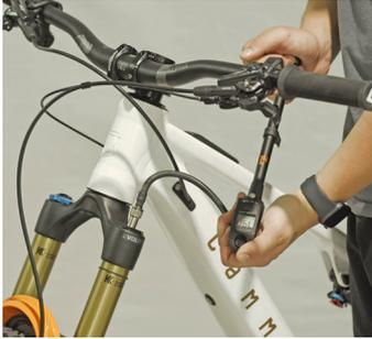
Es muy importante ajustar las suspensiones acorde a su peso. Para ello, infle sus suspensiones usando la bomba de alta presión. Para encontrar la presión correcta, consulte el manual del fabricante
