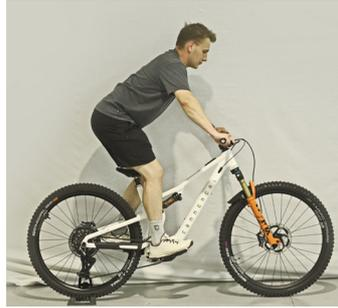
para conocer las presiones y configuraciones exactas. Para los amortiguadores de muelle, apriete su muelle para obtener el SAG correcto. (Hundimiento de las suspensiones).
