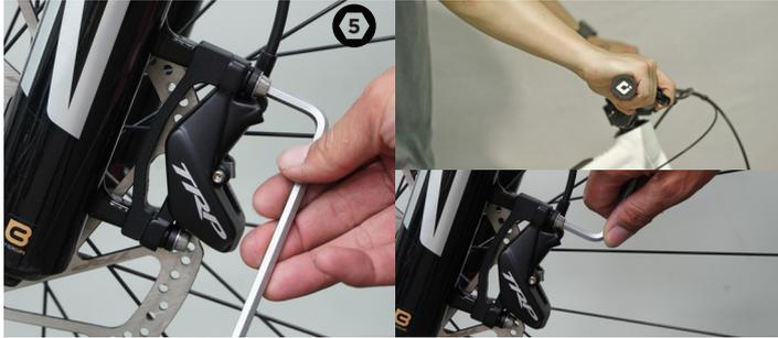
Para alinear la pinza con el disco, primero afloje los dos tornillos media vuelta para que la pinza se mueva. Gire la rueda y accione el freno correspondiente.
