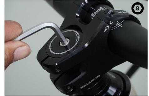
5) Apriete los tornillos de la potencia en la tija de la horquilla al par indicado en la potencia con la llave Allen correspondiente.
