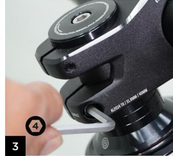
Si lo desea, puede ajustar la altura de su manillar cambiando la posición de los espaciadores. Para hacerlo, desatornille y quite la tapa de la dirección. Desatornille los 2 tornillos de la potencia. Retire la potencia y ajuste la posición de los espaciadores.
