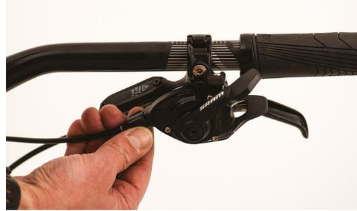
Una vez que se establecen los topes, ajuste la tensión del cable. Intente cambiar las velocidades:
