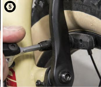
A l'aide d'une clé allen de 5mm, desserrez un patin et plaquez le contre la jante. Orientez le comme sur la photo et tout en le maintenant plaqué, resserrez la vis. Faites de même pour l'autre patin.
