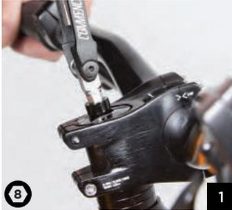
Vous pouvez, si vous le souhaitez, ajuster la hauteur de votre guidon en modifiant la position des entretoises. Pour cela dévissez et retirez le capot de direction. Dévissez les 2 vis de la potence. Retirez la potence et ajustez la position des entretoises.
