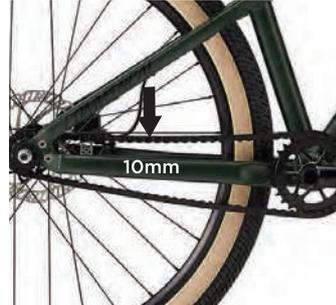
Pour les vélos mono vitesse, vérifiez que votre chaîne est assez tendue. Votre chaîne doit avoir un jeu vertical de 1cm environ à mi-distance entre l'axe de la roue et l'axe du pédalier. Si ce n'est pas le cas, retenez-la, soit en reculant votre roue, soit à l'aide du système de tension de chaîne.
