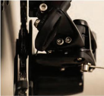
Les butées empêchent la chaîne de sortir de la cassette. Il y a une butée supérieure (H) et inférieure (L). La butée supérieure correspond au plus petit pignon de la cassette tandis que la butée inférieure correspond au plus grand. Il faut les serrer suffisamment pour limiter la course du dérailleur mais pas trop pour que tous les rapports de la cassette soient utilisables.
