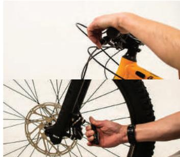
Tout en maintenant le frein actionné, resserrez les vis de l'étrier.
