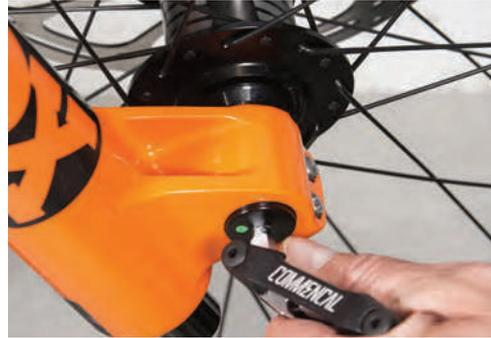
2) Installez la roue avant dans la fourche par le bas. Installez l'axe et serrez-le. Resserrez les 4 vis de blocage.
