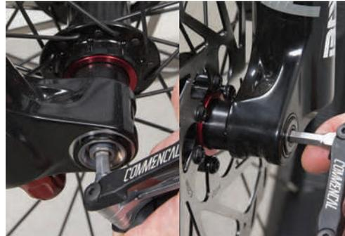
2) Serrez d'abord la vis de blocage (1) puis la vis de sécurité (2) (côté disque).
